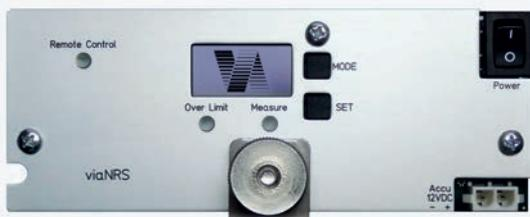
Bedienpanel im Akkugehäuse.
