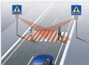
viafalcon PCD-1: Eine einzelne nach vorn gerichtete Detektionszone ermöglicht die Überwachung eines Fußgängerüberwegs vom Straßenrand her.
