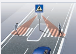
viafalcon PCD-2: Zwei unabhängige Detektionszonen (180°) erlauben die gleichzeitige Überwachung von zwei Fußgängerüberwegen z.B. von einer Fußgängerinsel aus.
